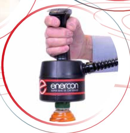
Dopo che il contenitore è stato riempito viene applicato il tappo (con all'interno un foglio di alluminio o sigillo). Una volta che il contenitore passa sotto la sigillatrice a induzione la bobina crea un campo elettromagnetico che scalda istantaneamente il foglio.
